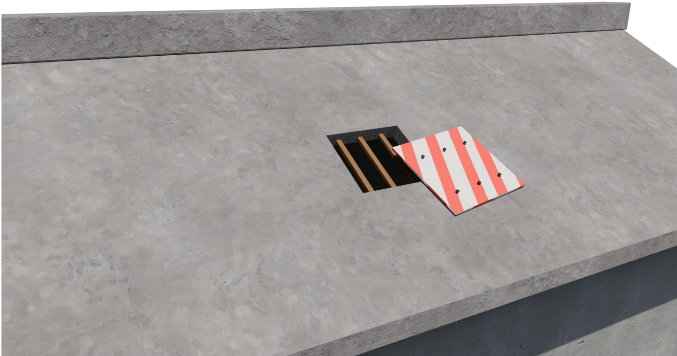
斜屋面小型洞口防护
