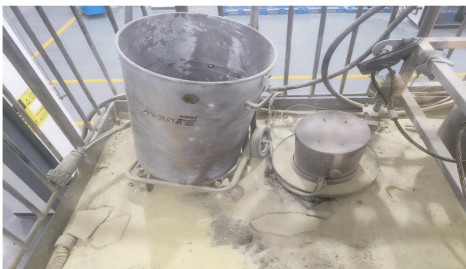
图 6 吸尘器不锈钢桶内壁灼烧痕迹
