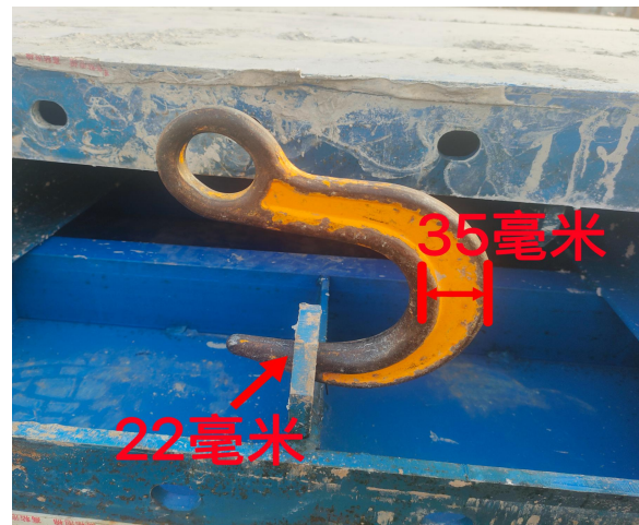
图 5 涉事吊钩吊孔图
