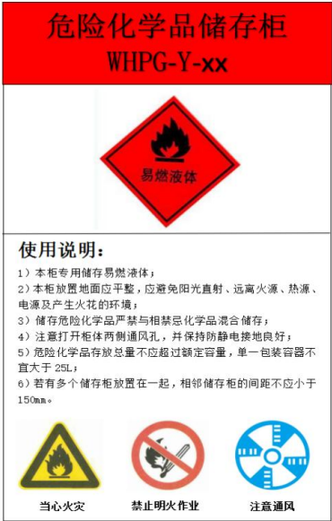
图 A.3 易燃液体储存柜标签
